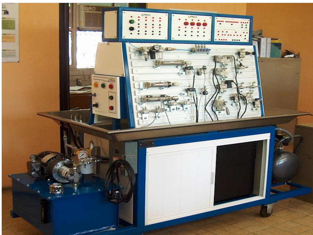
Fig. 2 vista de prototipo de banco de prácticas hidráulicas y neumáticas
